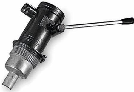
Bomba para transvase por sifonamiento, mediante palanca alternativa. El transvase por sifonamiento, una vez que la bomba ha sido cebada, proporciona un flujo continuo de 8 l/min. Válida para anticongelantes, disolventes, alcoholes, desengrasantes y otros fluidos industriales no corrosivos. Conexión a bidones 2" BSP (M) para bidones de 60/205 l. Incluye: flexible transparente de 1,5 m, boquerel metálico y tubo de aspiración en PVC.
